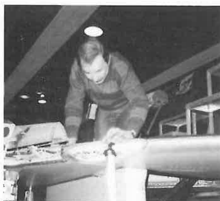
Kontrollingenjör Erling Mesin F21/SeÖN vid arbete med kontroll av kablagedlingar på fpl 37040.
