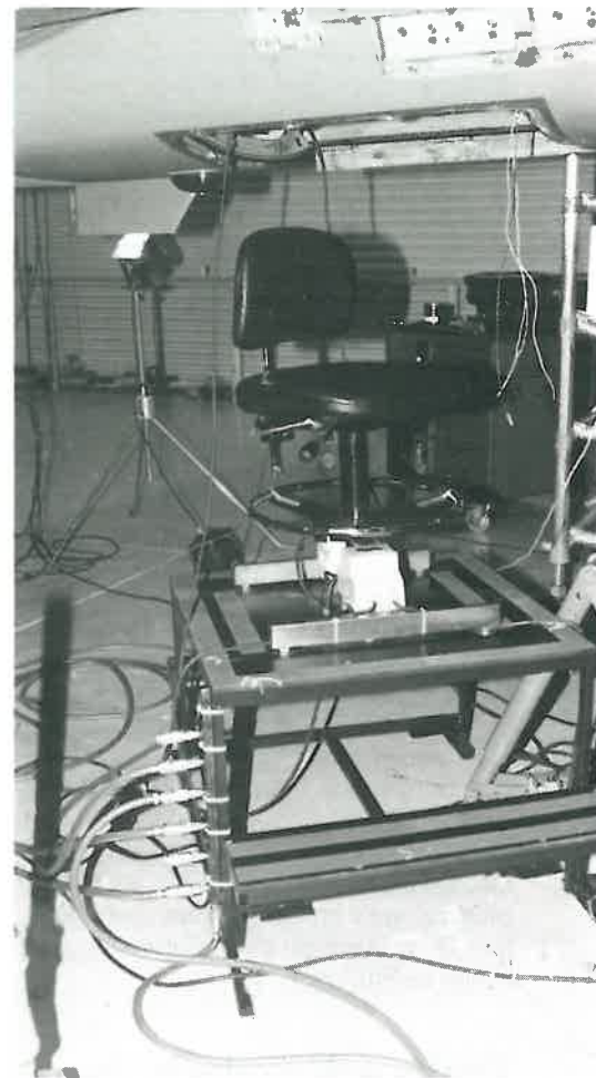
Exempel på arbetsstol vid modifiering av fpl 37040. Lagg märke till luftanslutningarna i stativet. (för tryckluftmaskiner etc.)
